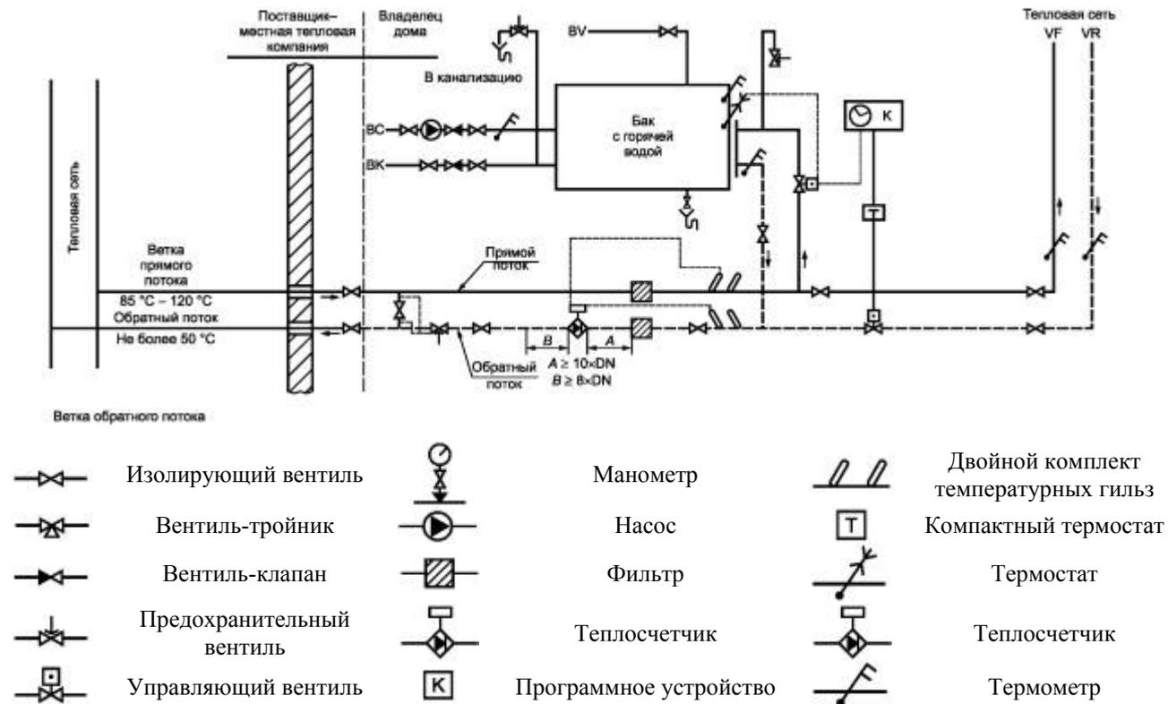
Рисунок А.1 - Типичная отопительная система для дома, прямой тип
