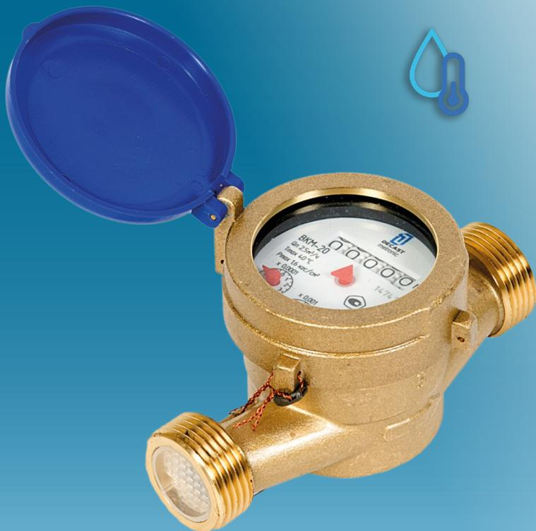
Счетчик крыльчатый мокроходный одноструйный холодной воды. Предназначен для установки в дачных домах и других объектах с малым расходом воды. Может быть установлен в помещениях с повышенной влажностью, а также затапливаемых колодцах. Декаст ВКМ ДГ может быть интегрирован в автоматизированную систему сбора данных (АСКУЭ).
