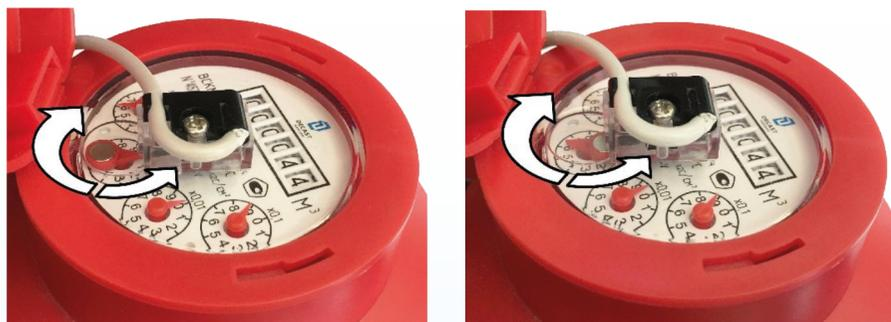
Геркон — электромеханическое устройство, изменяющее состояние подключённой электрической цепи при воздействии магнитного поля от постоянного магнита внутри счётчика
