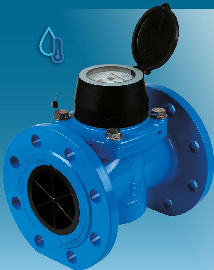
Промышленные счётчики холодной воды СТВХ «Стрим» класса «С». Предназначены для установки в многоквартирных домах и на предприятиях с широким диапазоном расходов. Рассчитаны для измерения объёма холодной воды с температурой до 50°C и давлением до 1,6 Мпа. Могут быть установлены в помещениях с повышенной влажностью.
